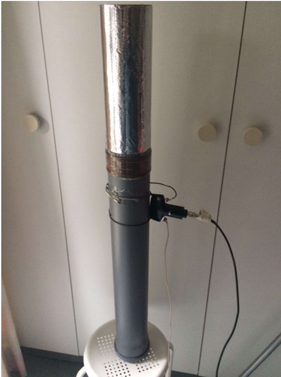
Abbildung 1 Erster Versuch mit einer Alu-Folie als Kapazität
